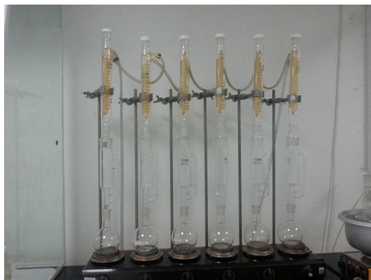
**Slika 7.6** Ekstraktor za pripremu uzoraka.
