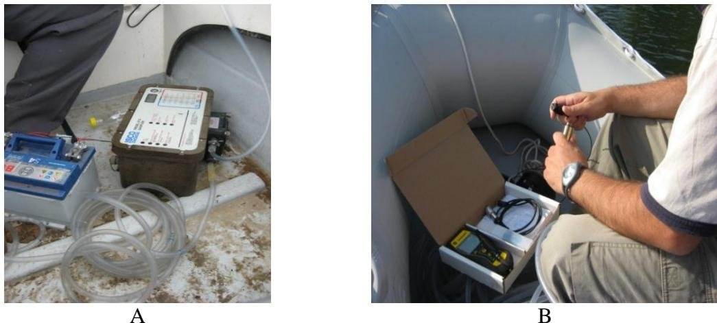
**Slika 6.3** Peristatička pumpa za uzorkovanje
