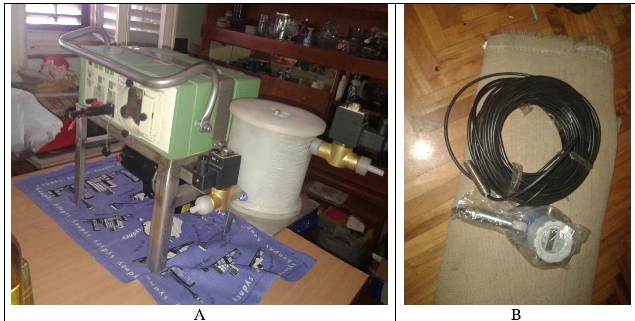
**Slika 8.2** Peristatička pumpa sa mernim rezervoarom (A) i merač dubine (B)
