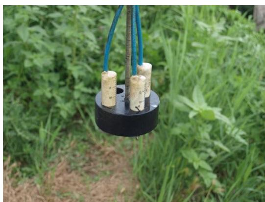
**Slika 7.4** Nosač pasivnog uzorkivača
